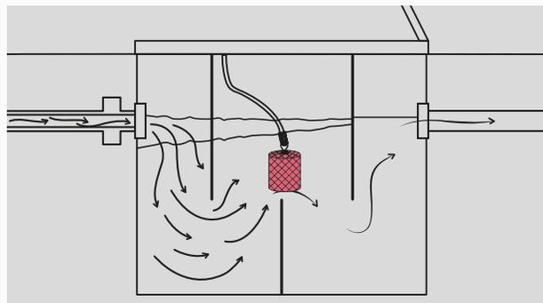
5 El **BIOBLOC22™** debe quedar ligeramente debajo de la superficie donde flotan las grasas, sin tocar el fondo de la trampa.
