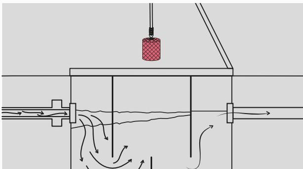
4 Coloque el **BIOBLOC22™** en un área con turbulencia media o baja, evitando zonas muertas donde no haya flujo de agua.
