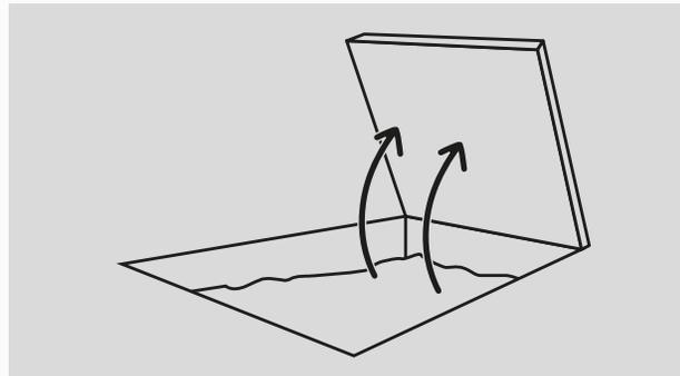
2 Levante la tapa de la trampa de grasa con precaución para permitir la colocación del **BIOBLOC22™** en su interior.
